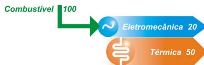
Figura 2-1 Cogeração, com produção de energia térmica e eletromecânica em simultâneo.
