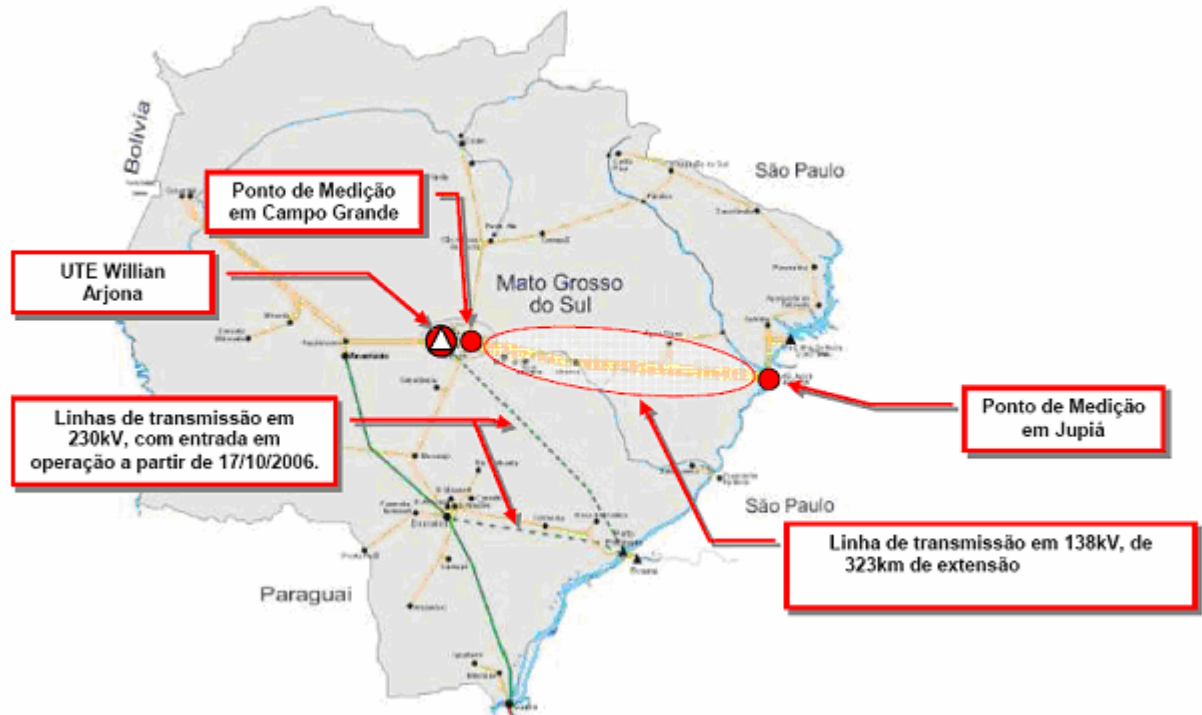
Figura 6 – Interligação do sistema elétrico da Enersul com a Rede Básica do SIN
