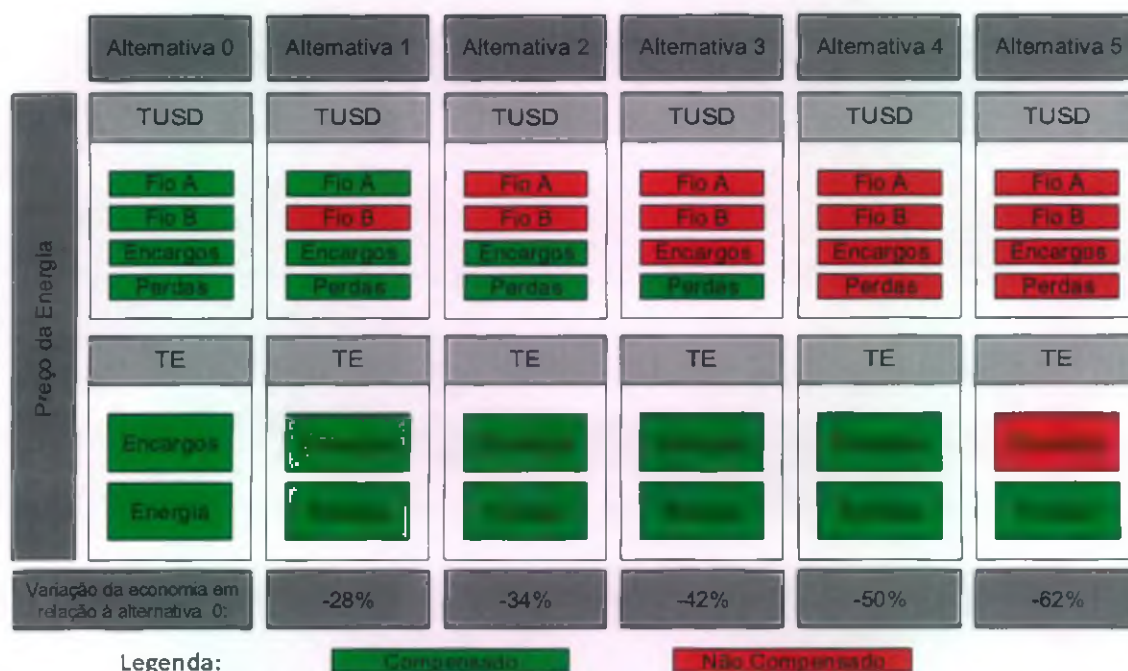
Figura 1: Cenários propostos e respectivos impactos médios na variação da economia do prosumidor com relação à alternativa 0.
