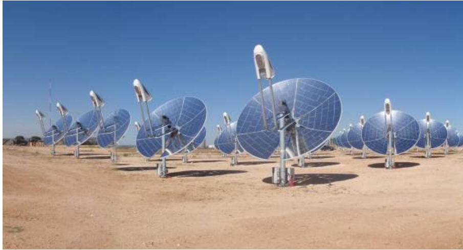
Figura 4: Tecnología de discos parabólicos
