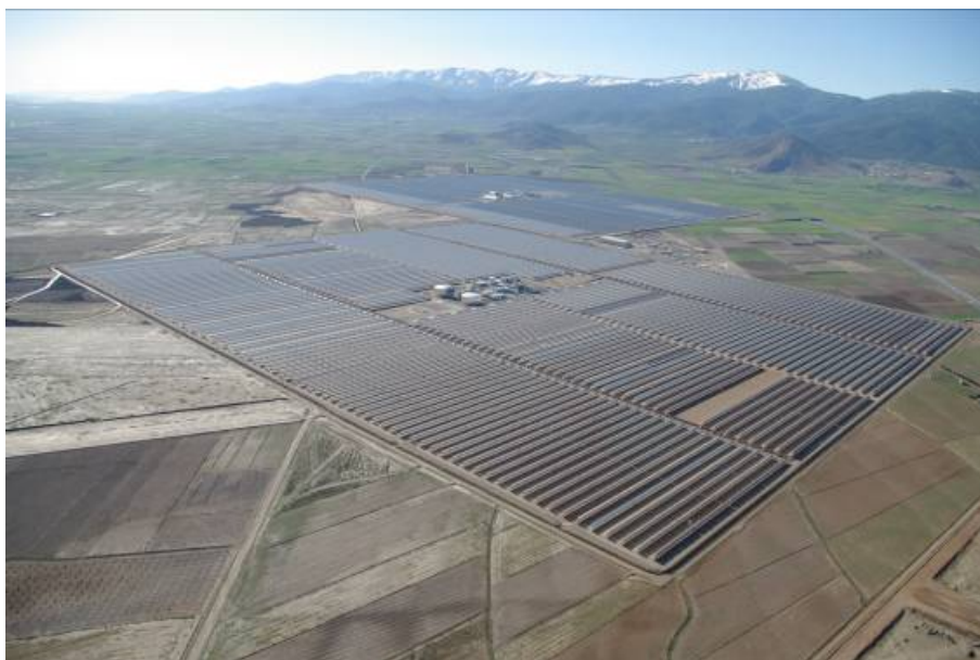
Figura 1: Tecnología de Canales parabólicos
